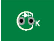
LEDは円形ですが向きが分かるようにカソード側が平になっています。基板のシルクはカソード側にシルク文字「K」があるので向きを合わせて実装します。
