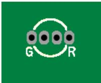
LEDは円形ですが部品の向きが分かるように片側が平になっています。基板のシルク文字「R」の方向にLEDの平な面を合わせて実装します。ランドの間隔が隣接しているので接触しないように注意しハンダ付けを行います。部品実装後にLEDの上にLED光拡散キャップを被せます。
